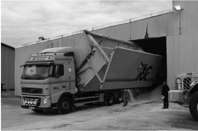
ペレット工場に、近隣からプレーナー屑が搬入される様子。荷台が横向きにダンプする
