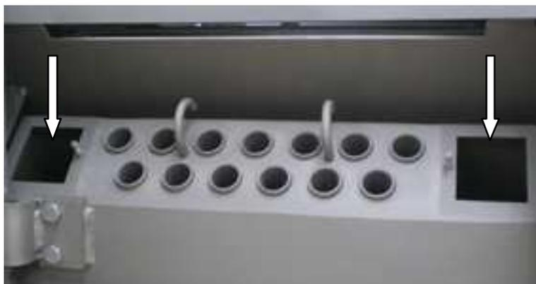
**下部清掃口：**熱交換器の手前についているバッフルプレートを外して下さい。(図18参照)
